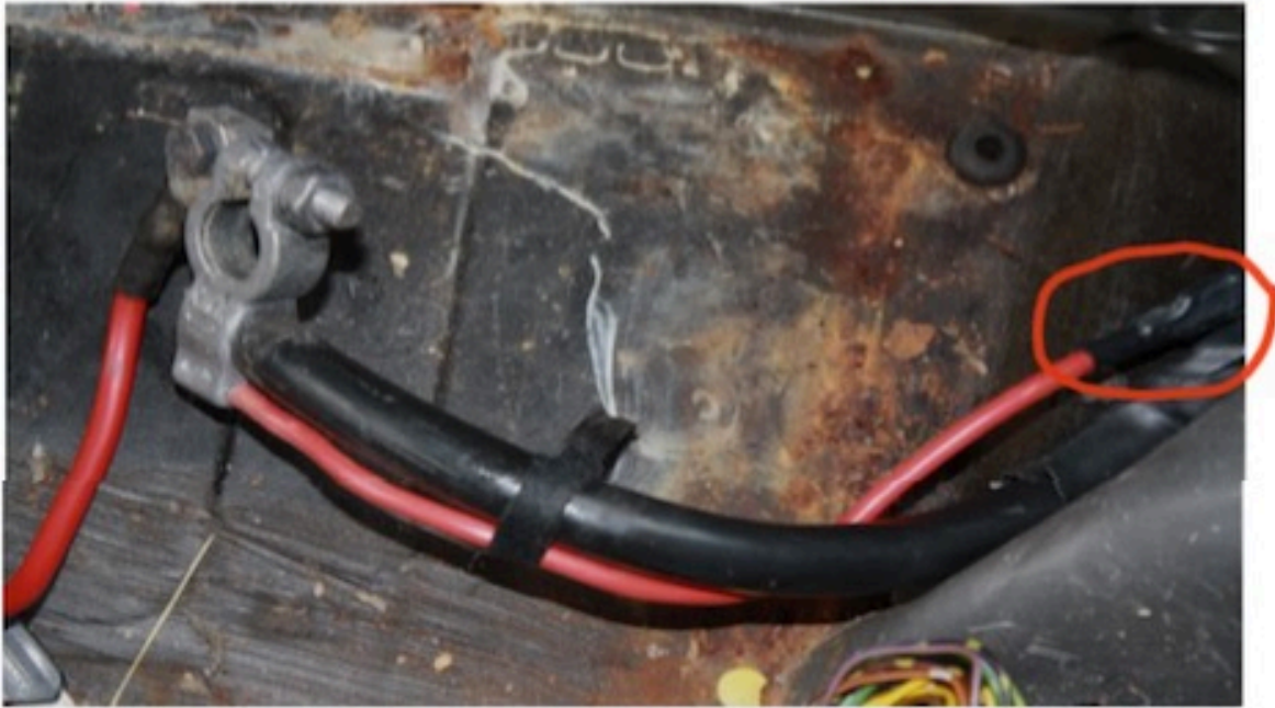
Fusible Link A
